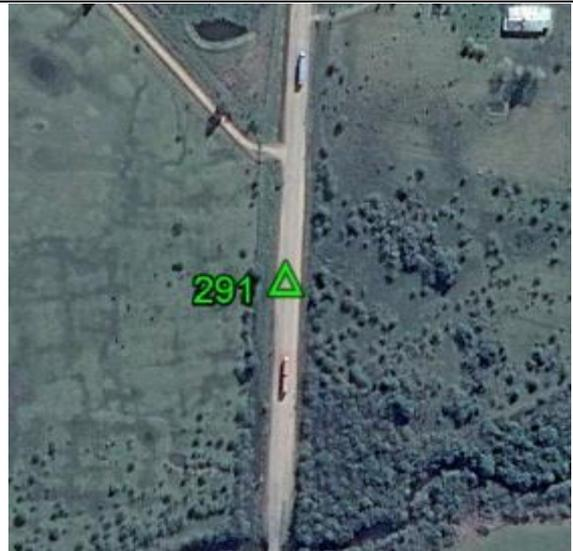
**Fecha: 04/10/2017****Modo de Levantamiento: RTK****Tipo / Modelo de antena utilizado: Trimble/ R8s Internal****Altura / Tipo de Medición de la antena: 2,000 / Base del montaje****Nombre de archivo Rinex: -****Observaciones: Punto recogido en el asfalto. Todas las unidades están en metros.****Ejecutado por:****Topocart - Topografía, Engenharia e Aerolevanteamento S/S Ltda.**
