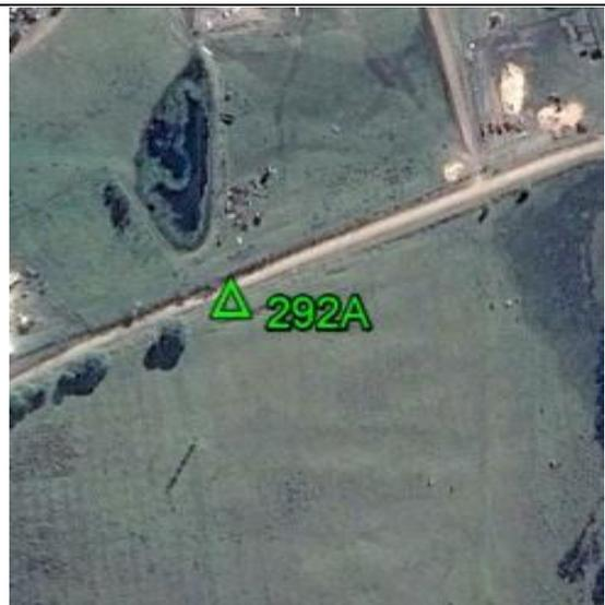
**Fecha: 04/10/2017****Modo de Levantamiento: RTK****Tipo / Modelo de antena utilizado: Trimble/ R8s Internal****Altura / Tipo de Medición de la antena: 2,000 / Base del montaje****Nombre de archivo Rinex: -****Observaciones: Punto recogido en el terreno. Todas las unidades están en metros.****Ejecutado por:****Topocart - Topografía, Engenharia e Aerolevantamento S/S Ltda.**
