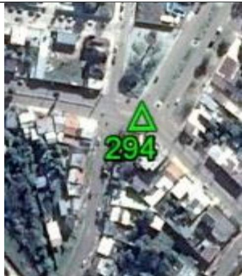
**Fecha: 04/10/2017****Modo de Levantamiento: RTK****Tipo / Modelo de antena utilizado: Trimble/ R8s Internal****Altura / Tipo de Medición de la antena: 2,000 / Base del montaje****Nombre de archivo Rinex: -****Observaciones: Punto recogido en la calzada central de la vía. Todas las unidades están en metros.****Ejecutado por:****Topocart - Topografía, Engenharia e Aerolevanteamento S/S Ltda.**
