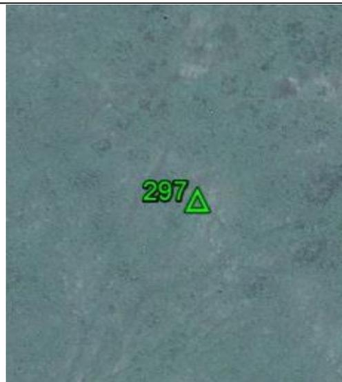
**Fecha: 04/10/2017****Modo de Levantamiento: RTK****Tipo / Modelo de antena utilizado: Trimble/ R8s Internal****Altura / Tipo de Medición de la antena: 2,000 / Base del montaje****Nombre de archivo Rinex: -****Observaciones: Punto recogido en el terreno. Todas las unidades están en metros.****Ejecutado por:****Topocart - Topografía, Engenharia e Aerolevanteamento S/S Ltda.**
