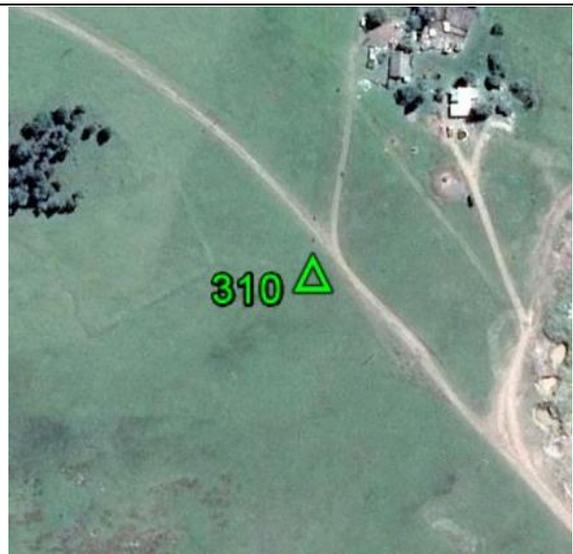
**Fecha: 05/10/2017****Modo de Levantamiento: RTK****Tipo / Modelo de antena utilizado: Trimble/ R8s Internal****Altura / Tipo de Medición de la antena: 2,000 / Base del montaje****Nombre de archivo Rinex: -****Observaciones: Punto recogido en el terreno. Todas las unidades están en metros.****Ejecutado por:****Topocart - Topografía, Engenharia e Aerolevantamento S/S Ltda.**
