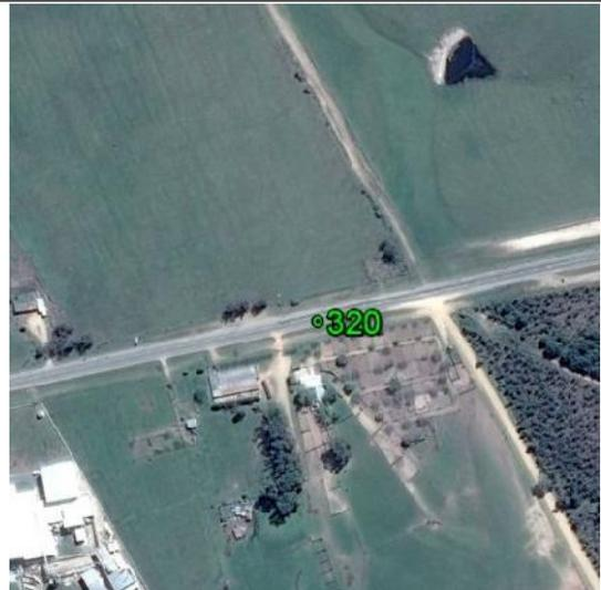
**Fecha: 19/07/2017****Modo de Levantamiento: RTK****Tipo / Modelo de antena utilizado: Trimble/ R8s Internal****Altura / Tipo de Medición de la antena: 2,000 / Base del montaje****Nombre de archivo Rinex: -****Observaciones: Punto recogido en el suelo pavimentado. Todas las unidades están en metros.****Ejecutado por:****Topocart - Topografía, Engenharia e Aerolevantamento S/S Ltda.**
