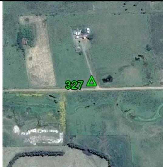
**Fecha: 25/06/2017****Modo de Levantamiento: RTK****Tipo / Modelo de antena utilizado: Trimble/ R8s Internal****Altura / Tipo de Medición de la antena: 2,000 / Base del montaje****Nombre de archivo Rinex: -****Observaciones: Punto recogido en la tapa de la caja de concreto. Todas las unidades están en metros.****Ejecutado por:****Topocart - Topografía, Engenharia e Aerolevantamento S/S Ltda.**
