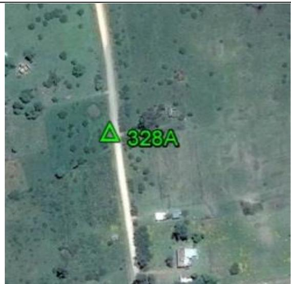
**Fecha: 25/06/2017****Modo de Levantamiento: RTK****Tipo / Modelo de antena utilizado: Trimble/ R8s Internal****Altura / Tipo de Medición de la antena: 2,000 / Base del montaje****Nombre de archivo Rinex: -****Observaciones: El punto fue tomado en el terreno. Todas las unidades están en metros.****Ejecutado por:****Topocart - Topografía, Engenharia e Aerolevanteamento S/S Ltda.**
