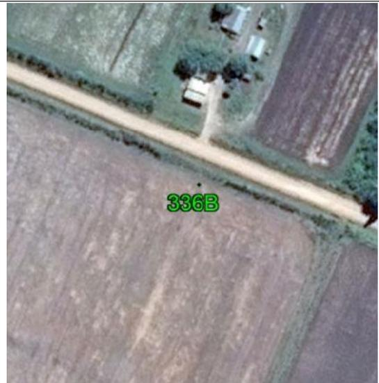
**Fecha: 22/06/2017****Modo de Levantamiento: RTK****Tipo / Modelo de antena utilizado: Trimble / R8s Internal****Altura / Tipo de Medición de la antena: 2,000 / Base del montaje****Nombre de archivo Rinex: -****Observaciones: Punto recogido en el terreno. Todas las unidades están en metros.****Ejecutado por:****Topocart - Topografía, Engenharia e Aerolevantamento S/S Ltda.**
