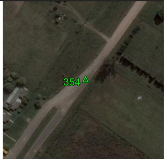
**Fecha: 25/06/2017****Modo de Levantamiento: RTK****Tipo / Modelo de antena utilizado: Trimble/ R8s Internal****Altura / Tipo de Medición de la antena: 2,000 / Base del montaje****Nombre de archivo Rinex: -****Observaciones: Punto recogido en el asfalto. Todas las unidades están en metros.****Ejecutado por:****Topocart - Topografía, Engenharia e Aerolevantamento S/S Ltda.**
