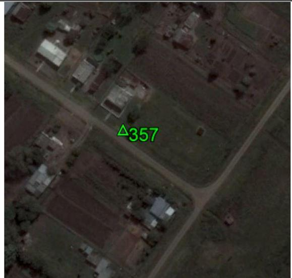
**Fecha: 25/06/2017****Modo de Levantamiento: RTK****Tipo / Modelo de antena utilizado: Trimble/ R8s Internal****Altura / Tipo de Medición de la antena: 2,000 / Base del montaje****Nombre de archivo Rinex: -****Observaciones: Punto fue recopilado en el terreno. Todas las unidades están en metros.****Ejecutado por:****Topocart - Topografía, Engenharia e Aerolevanteamento S/S Ltda.**
