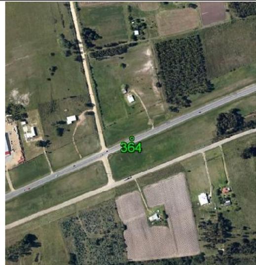
**Fecha: 21/06/2017****Modo de Levantamiento: RTK****Tipo / Modelo de antena utilizado: Trimble/ R8s Internal****Altura / Tipo de Medición de la antena: 2,000 / Base del montaje****Nombre de archivo Rinex: -****Observaciones: Punto recogido en el suelo pavimentado. Todas las unidades están en metros.****Ejecutado por:****Topocart - Topografía, Engenharia e Aerolevantamento S/S Ltda.**
