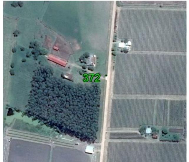
**Fecha: 12/06/2017****Modo de Levantamiento: RTK****Tipo / Modelo de antena utilizado: Trimble / R8s Internal****Altura / Tipo de Medición de la antena: 2,000 / Base del montaje****Nombre de archivo Rinex: -****Observaciones:** Punto recogido en la junta del piso de hormigón. Todas las unidades están en metros.**Ejecutado por:****Topocart - Topografía, Engenharia e Aerolevanteamento S/S Ltda.**
