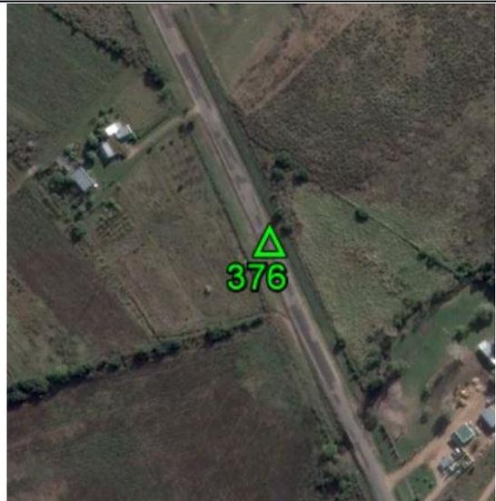
**Fecha: 12/06/2017****Modo de Levantamiento: RTK****Tipo / Modelo de antena utilizado: Trimble/ R8s Internal****Altura / Tipo de Medición de la antena: 2,000 / Base del montaje****Nombre de archivo Rinex: -****Observaciones: Punto recogido en el asfalto. Todas las unidades están en metros.****Ejecutado por:****Topocart - Topografía, Engenharia e Aerolevantamento S/S Ltda.**
