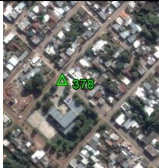
**Fecha: 12/06/2017****Modo de Levantamiento: RTK****Tipo / Modelo de antena utilizado: Trimble/ R8s Internal****Altura / Tipo de Medición de la antena: 2,000 / Base del montaje****Nombre de archivo Rinex: -****Observaciones: Punto recogido en la calzada. Todas las unidades están en metros.****Ejecutado por:****Topocart - Topografía, Engenharia e Aerolevantamento S/S Ltda.**
