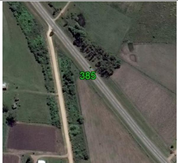
**Fecha: 23/06/2017****Modo de Levantamiento: RTK****Tipo / Modelo de antena utilizado: Trimble / R8s Internal****Altura / Tipo de Medición de la antena: 2,000 / Base del montaje****Nombre de archivo Rinex: -****Observaciones:** Punto recogido en el suelo pavimentado. Todas las unidades están en metros.**Ejecutado por:****Topocart - Topografía, Engenharia e Aerolevantamento S/S Ltda.**
