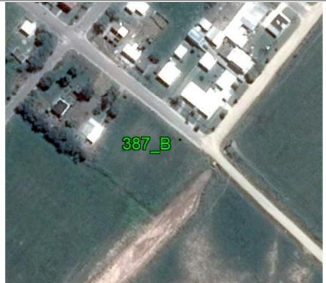
**Fecha: 27/06/2017****Modo de Levantamiento: RTK****Tipo / Modelo de antena utilizado: Trimble / R8s Internal****Altura / Tipo de Medición de la antena: 2,000 / Base del montaje****Nombre de archivo Rinex: -****Observaciones:** Punto recogido en el suelo pavimentado. Todas las unidades están en metros.**Ejecutado por:****Topocart - Topografía, Engenharia e Aerolevantamento S/S Ltda.**
