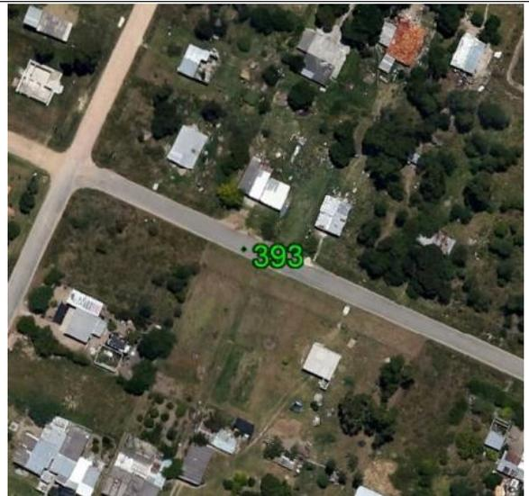
**Fecha: 27/06/2017****Modo de Levantamiento: RTK****Tipo / Modelo de antena utilizado: Trimble / R8s Internal****Altura / Tipo de Medición de la antena: 2,000 / Base del montaje****Nombre de archivo Rinex: -****Observaciones: Punto recogido en el suelo pavimentado. Todas las unidades están en metros.****Ejecutado por:****Topocart - Topografía, Engenharia e Aerolevantamento S/S Ltda.**
