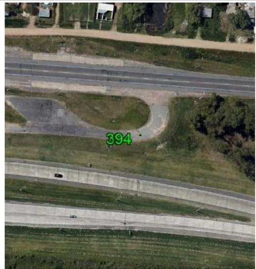
**Fecha: 27/06/2017****Modo de Levantamiento: RTK****Tipo / Modelo de antena utilizado: Trimble / R8s Internal****Altura / Tipo de Medición de la antena: 2,000 / Base del montaje****Nombre de archivo Rinex: -****Observaciones:** Punto recogido en el suelo pavimentado. Todas las unidades están en metros.**Ejecutado por:****Topocart - Topografía, Engenharia e Aerolevantamento S/S Ltda.**
