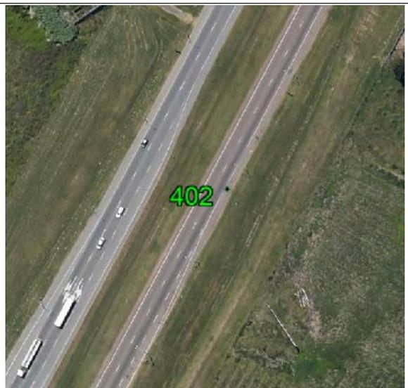
**Fecha: 08/07/2017****Modo de Levantamiento: RTK****Tipo / Modelo de antena utilizado: Trimble / R8s Internal****Altura / Tipo de Medición de la antena: 2,000 / Base del montaje****Nombre de archivo Rinex: -****Observaciones:** Punto recogido en el suelo pavimentado. Todas las unidades están en metros.**Ejecutado por:****Topocart - Topografía, Engenharia e Aerolevantamento S/S Ltda.**
