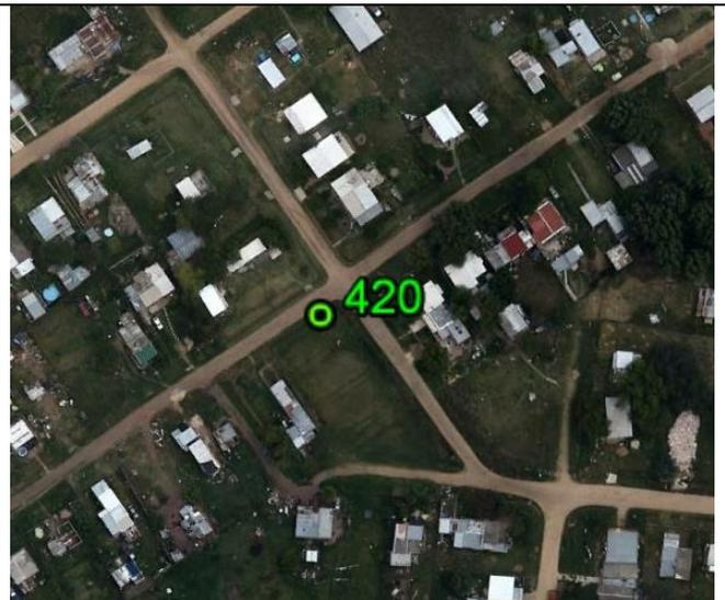
**Fecha: 11/07/2017****Modo de Levantamiento: RTK****Tipo / Modelo de antena utilizado: Trimble/ R8s Internal****Altura / Tipo de Medición de la antena: 2,000 / Base del montaje****Nombre de archivo Rinex: -****Observaciones:** Punto recogido en la esquina de uno piso de hormigón. Todas las unidades están en metros.**Ejecutado por:****Topocart - Topografía, Engenharia e Aerolevantamento S/S Ltda.**
