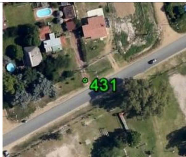
**Fecha: 11/07/2017****Modo de Levantamiento: RTK****Tipo / Modelo de antena utilizado: Trimble/ R6-4 Internal****Altura / Tipo de Medición de la antena: 2,000 / Base del montaje****Nombre de archivo Rinex: -****Observaciones: Punto recogido en la acera .Todas las unidades están en metros.****Ejecutado por:****Topocart - Topografía, Engenharia e Aerolevanteamento S/S Ltda.**
