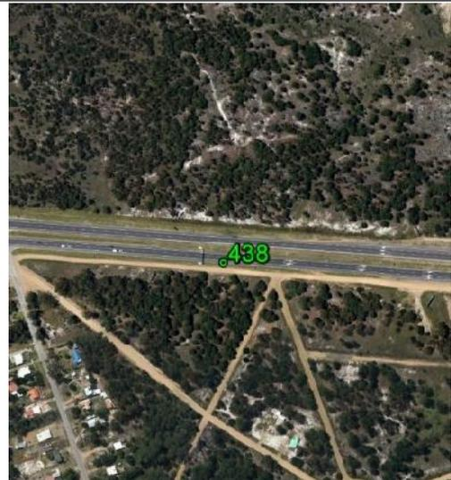
**Fecha:** 13/07/2017**Modo de Levantamiento:** RTK**Tipo / Modelo de antena utilizado:** Trimble/ R8s Internal**Altura / Tipo de Medición de la antena:** 2,000 / Base del montaje**Nombre de archivo Rinex:** -**Observaciones:** Punto recogido en el suelo pavimentado. Todas las unidades están en metros.**Ejecutado por:****Topocart - Topografía, Engenharia e Aerolevantamento S/S Ltda.**
