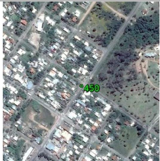
**Fecha: 21/07/2017****Modo de Levantamiento: RTK****Tipo / Modelo de antena utilizado: Trimble/ R8s Internal****Altura / Tipo de Medición de la antena: 2,000 / Base del montaje****Nombre de archivo Rinex: -****Observaciones: Punto recogido en la acera. Todas las unidades están en metros.****Ejecutado por:****Topocart - Topografía, Engenharia e Aerolevantamento S/S Ltda.**
