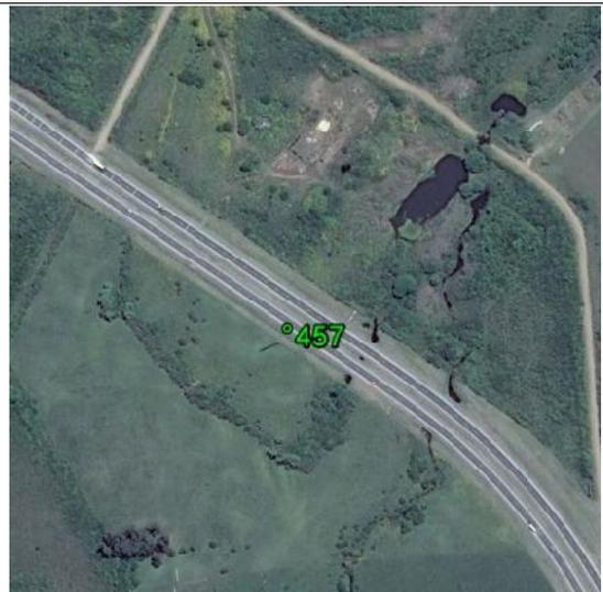
**Fecha: 25/06/2017****Modo de Levantamiento: RTK****Tipo / Modelo de antena utilizado: Trimble/ R8s Internal****Altura / Tipo de Medición de la antena: 2,000 / Base del montaje****Nombre de archivo Rinex: -****Observaciones: Punto recogido en el suelo pavimentado. Todas las unidades están en metros.****Ejecutado por:****Topocart - Topografía, Engenharia e Aerolevantamento S/S Ltda.**
