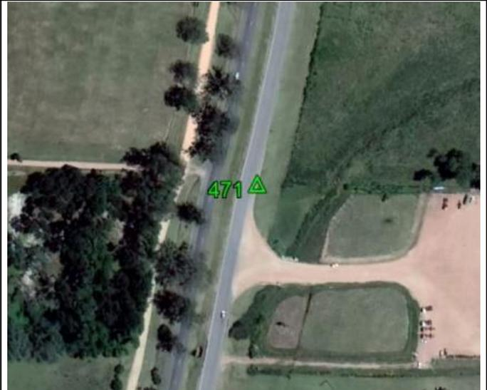
**Fecha: 21/07/2017****Modo de Levantamiento: Estático****Tipo / Modelo de antena utilizado: Trimble/ R8s Internal****Altura / Tipo de Medición de la antena: 2,000 / Base del montaje****Nombre de archivo Rinex: 471\_2020****Observaciones: Punto recogido en el asfalto .Todas las unidades están en metros.****Ejecutado por:****Topocart - Topografía, Engenharia e Aerolevantamento S/S Ltda.**
