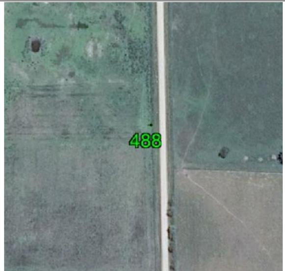
**Fecha: 22/06/2017****Modo de Levantamiento: RTK****Tipo / Modelo de antena utilizado: Trimble / R8s Internal****Altura / Tipo de Medición de la antena: 2,000 / Base del montaje****Nombre de archivo Rinex: -****Observaciones: Punto recogido en el terreno. Todas las unidades están en metros.****Ejecutado por:****Topocart - Topografía, Engenharia e Aerolevantamento S/S Ltda.**
