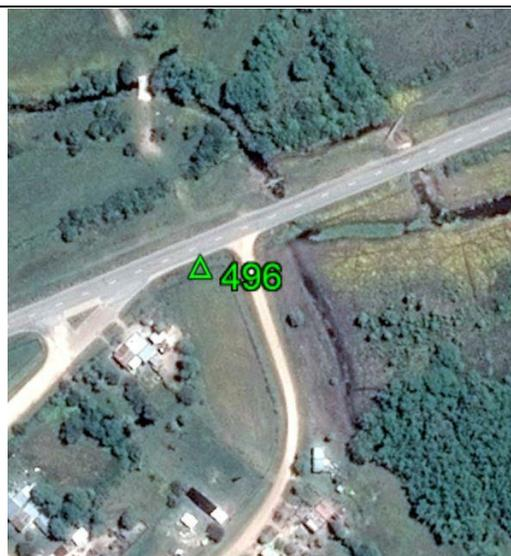
**Fecha: 03/10/2017****Modo de Levantamiento: RTK****Tipo / Modelo de antena utilizado: Trimble/ R8s Internal****Altura / Tipo de Medición de la antena: 2,000 / Base del montaje****Nombre de archivo Rinex: -****Observaciones: Punto recogido sobre la caja redonda de concreto. Todas las unidades están en metros.****Ejecutado por:****Topocart - Topografía, Engenharia e Aerolevantamento S/S Ltda.**
