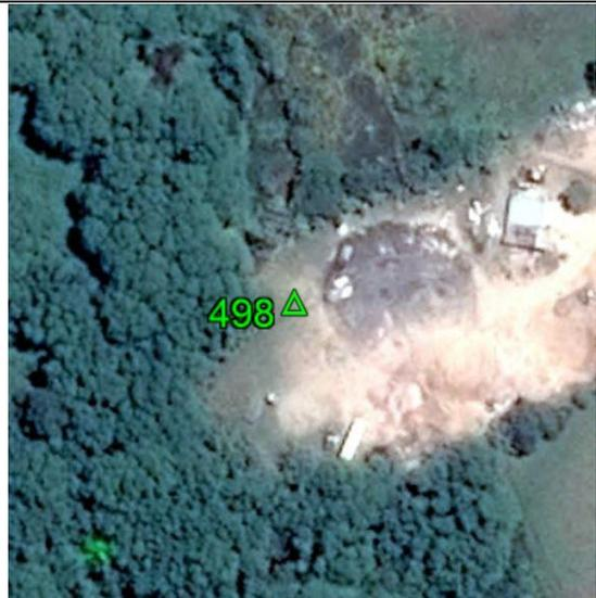
**Fecha: 03/10/2017****Modo de Levantamiento: RTK****Tipo / Modelo de antena utilizado: Trimble/ R8s Internal****Altura / Tipo de Medición de la antena: 2,000 / Base del montaje****Nombre de archivo Rinex: -****Observaciones: Punto recogido en el terreno. Todas las unidades están en metros.****Ejecutado por:****Topocart - Topografía, Engenharia e Aerolevantamento S/S Ltda.**
