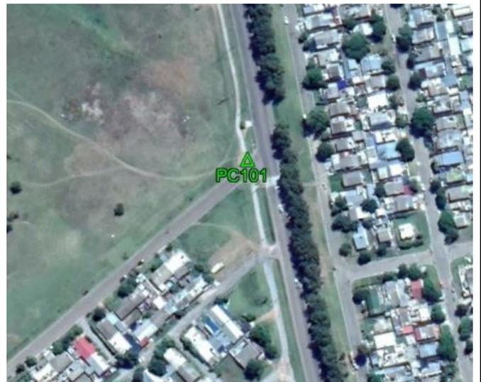
**Fecha: 21/07/2017****Modo de Levantamiento: RTK****Tipo / Modelo de antena utilizado: Trimble/ R8s Internal****Altura / Tipo de Medición de la antena: 2,000 / Base del montaje****Nombre de archivo Rinex: -****Observaciones: Punto recogido en la esquina de la caja de concreto. Todas las unidades están en metros.****Ejecutado por:****Topocart - Topografía, Engenharia e Aerolevantamento S/S Ltda.**
