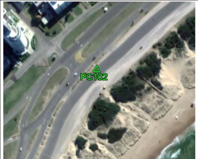
**Fecha: 21/07/2017****Modo de Levantamiento: RTK****Tipo / Modelo de antena utilizado: Trimble/ R8s Internal****Altura / Tipo de Medición de la antena: 2,000 / Base del montaje****Nombre de archivo Rinex: -****Observaciones: Punto recogido en el asfalto. Todas las unidades están en metros.****Ejecutado por:****Topocart - Topografía, Engenharia e Aerolevantamento S/S Ltda.**
