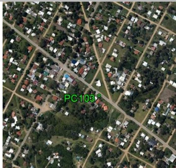
**Fecha: 13/07/2017****Modo de Levantamiento: RTK****Tipo / Modelo de antena utilizado: Trimble/ R8s Internal****Altura / Tipo de Medición de la antena: 2,000 / Base del montaje****Nombre de archivo Rinex: -****Observaciones:** Punto recogido en la esquina de la acera. Todas las unidades están en metros.**Ejecutado por:****Topocart - Topografía, Engenharia e Aerolevantamento S/S Ltda.**
