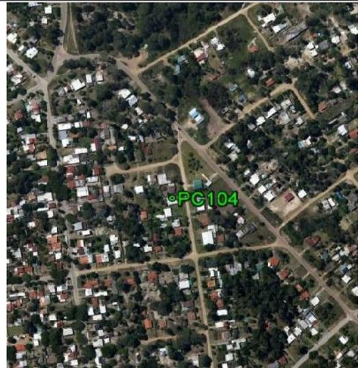
**Fecha: 13/07/2017****Modo de Levantamiento: RTK****Tipo / Modelo de antena utilizado: Trimble/ R8s Internal****Altura / Tipo de Medición de la antena: 2,000 / Base del montaje****Nombre de archivo Rinex: -****Observaciones: Punto recogido en la junta del piso de hormigón. Todas las unidades están en metros.****Ejecutado por:****Topocart - Topografía, Engenharia e Aerolevantamento S/S Ltda.**
