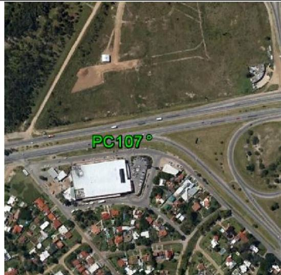
**Fecha: 11/07/2017****Modo de Levantamiento: RTK****Tipo / Modelo de antena utilizado: Trimble/ R8s Internal****Altura / Tipo de Medición de la antena: 2,000 / Base del montaje****Nombre de archivo Rinex: -****Observaciones:** Punto recogido en el suelo pavimentado. Todas las unidades están en metros.**Ejecutado por:****Topocart - Topografía, Engenharia e Aerolevantamento S/S Ltda.**
