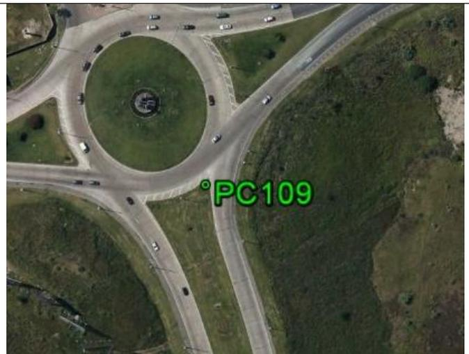
**Fecha: 11/07/2017****Modo de Levantamiento: RTK****Tipo / Modelo de antena utilizado: Trimble/ R6-4 Internal****Altura / Tipo de Medición de la antena: 2,000 / Base del montaje****Nombre de archivo Rinex: -****Observaciones: Punto recogido en el suelo pavimentado. Todas las unidades están en metros.****Ejecutado por:****Topocart - Topografía, Engenharia e Aerolevanteamento S/S Ltda.**
