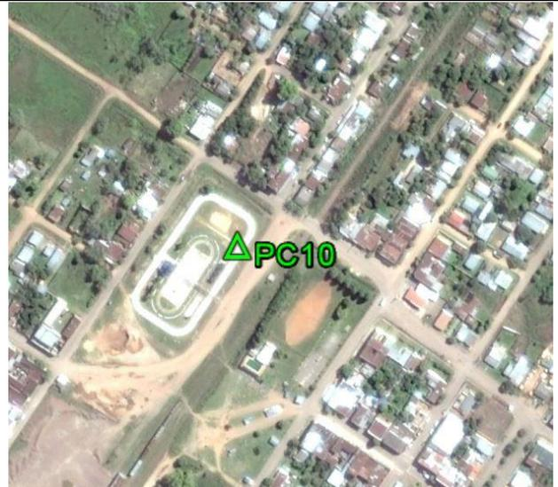
**Fecha: 06/10/2017****Modo de Levantamiento: RTK****Tipo / Modelo de antena utilizado: Trimble/ R8s Internal****Altura / Tipo de Medición de la antena: 2,000 / Base del montaje****Nombre de archivo Rinex: -****Observaciones:** Punto recogido en la esquina de la base de concreto. Todas las unidades están en metros.**Ejecutado por:****Topocart - Topografía, Engenharia e Aerolevantamento S/S Ltda.**
