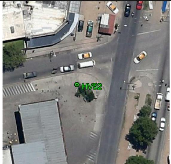
**Fecha: 26/03/2017****Modo de Levantamiento: Estático****Tipo / Modelo de antena utilizado: Topcon / Hiper II****Altura / Tipo de Medición de la antena: 2,000m / Base del montaje****Nombre de archivo Rinex: PC114A\_0854****Observaciones: Punto recogido en la esquina de la acera. Todas las unidades están en metros.****Ejecutado por:****Topocart - Topografía, Engenharia e Aerolevanteamento S/S Ltda.**
