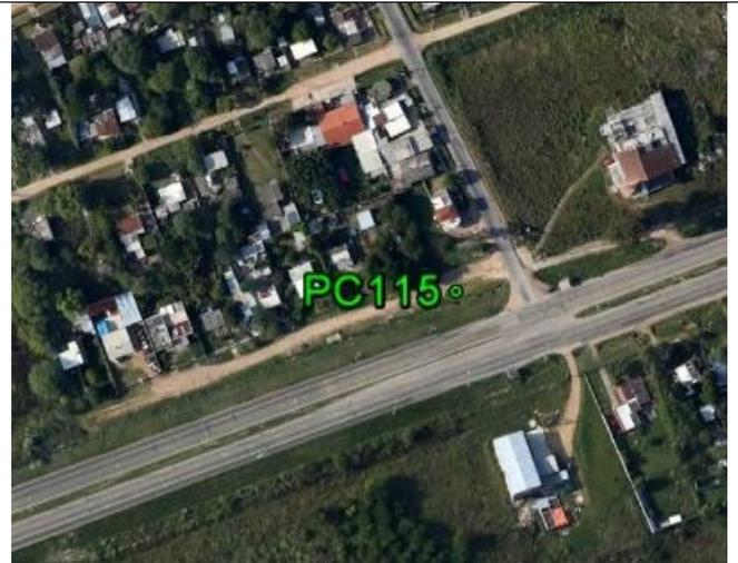
**Fecha: 11/07/2017****Modo de Levantamiento: RTK****Tipo / Modelo de antena utilizado: Trimble/ R6-4 Internal****Altura / Tipo de Medición de la antena: 2,000 / Base del montaje****Nombre de archivo Rinex: -****Observaciones: Punto recogido en la esquina de una base de hormigón. Todas las unidades están en metros.****Ejecutado por:****Topocart - Topografía, Engenharia e Aerolevantamento S/S Ltda.**
