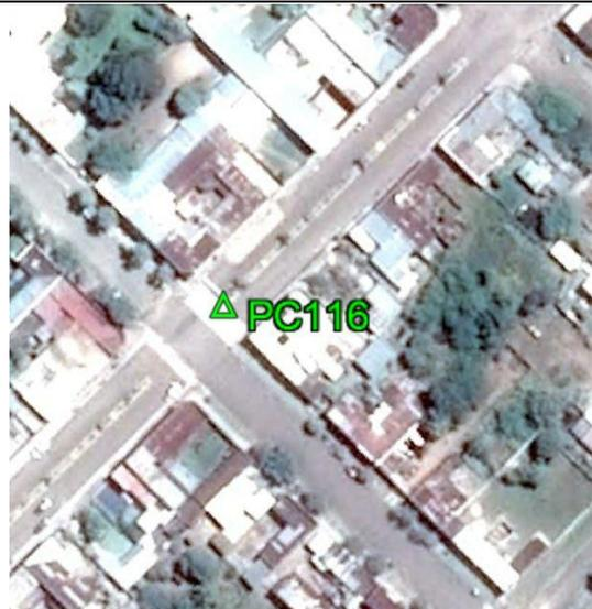
**Fecha: 03/10/2017****Modo de Levantamiento: RTK****Tipo / Modelo de antena utilizado: Trimble/ R8s Internal****Altura / Tipo de Medición de la antena: 2,000 / Base del montaje****Nombre de archivo Rinex: -****Observaciones: Punto recogido en el asfalto. Todas las unidades están en metros.****Ejecutado por:****Topocart - Topografía, Engenharia e Aerolevanteamento S/S Ltda.**
