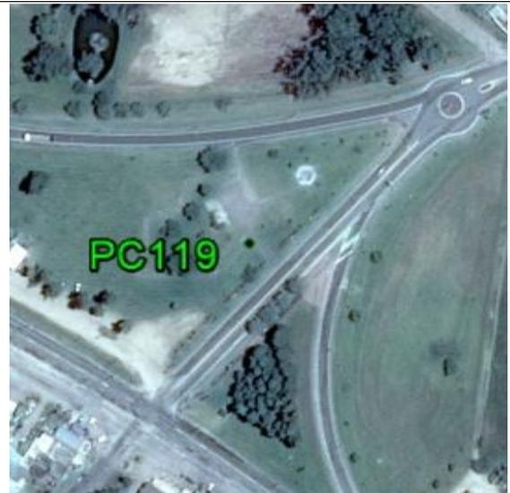
**Fecha: 28/01/2017****Modo de Levantamiento: RTK****Tipo / Modelo de antena utilizado: Trimble / R6-4 Internal****Altura / Tipo de Medición de la antena: 2,000 / Base del montaje****Nombre de archivo Rinex: -****Observaciones: Punto recogido en la esquina de la acera. Todas las unidades están en metros.****Ejecutado por:****Topocart - Topografía, Engenharia e Aerolevantamento S/S Ltda.**
