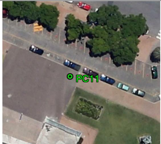
**Fecha: 06/10/2017****Modo de Levantamiento: RTK****Tipo / Modelo de antena utilizado: Trimble/ R8s Internal****Altura / Tipo de Medición de la antena: 2,000 / Base del montaje****Nombre de archivo Rinex: -****Observaciones: Punto recogido en la acera .Todas las unidades están en metros.****Ejecutado por:****Topocart - Topografía, Engenharia e Aerolevantamento S/S Ltda.**
