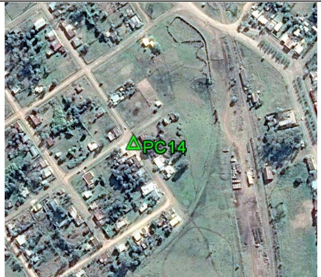
**Fecha: 06/10/2017****Modo de Levantamiento: RTK****Tipo / Modelo de antena utilizado: Trimble/ R8s Internal****Altura / Tipo de Medición de la antena: 2,000 / Base del montaje****Nombre de archivo Rinex: -****Observaciones: Punto recogido en el asfalto. Todas las unidades están en metros.****Ejecutado por:****Topocart - Topografía, Engenharia e Aerolevanteamento S/S Ltda.**
