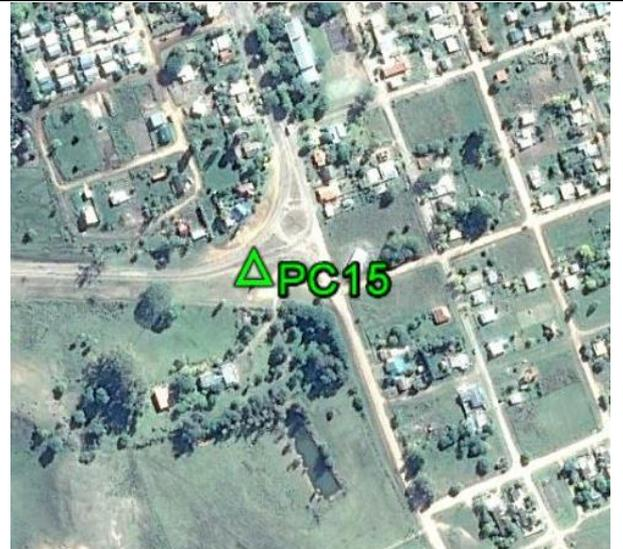
**Fecha: 02/10/2017****Modo de Levantamiento: RTK****Tipo / Modelo de antena utilizado: Trimble/ R8s Internal****Altura / Tipo de Medición de la antena: 2,000 / Base del montaje****Nombre de archivo Rinex: -****Observaciones:** Punto recogido en la esquina de la base de concreto. Todas las unidades están en metros.**Ejecutado por:****Topocart - Topografía, Engenharia e Aerolevantamento S/S Ltda.**
