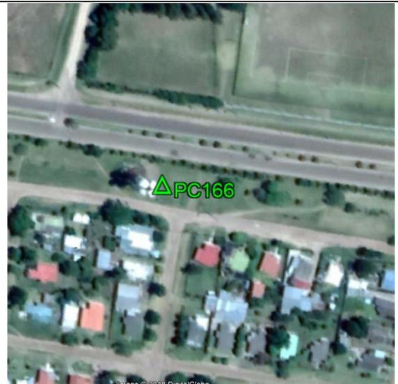
**Fecha: 08/10/2017****Modo de Levantamiento: RTK****Tipo / Modelo de antena utilizado: Trimble/ R8s Internal****Altura / Tipo de Medición de la antena: 2,000 / Base del montaje****Nombre de archivo Rinex: -****Observaciones: Punto recogido en la tapa de concreto. Todas las unidades están en metros.****Ejecutado por:****Topocart - Topografía, Engenharia e Aerolevantamento S/S Ltda.**
