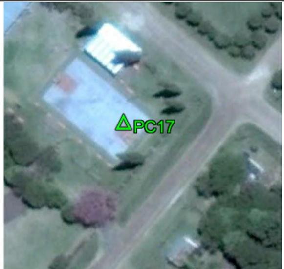
**Fecha: 08/10/2017****Modo de Levantamiento: RTK****Tipo / Modelo de antena utilizado: Trimble/ R8s Internal****Altura / Tipo de Medición de la antena: 2,000 / Base del montaje****Nombre de archivo Rinex: -****Observaciones: Punto recogido en el piso de la cancha. Todas las unidades están en metros.****Ejecutado por:****Topocart - Topografía, Engenharia e Aerolevantamento S/S Ltda.**
