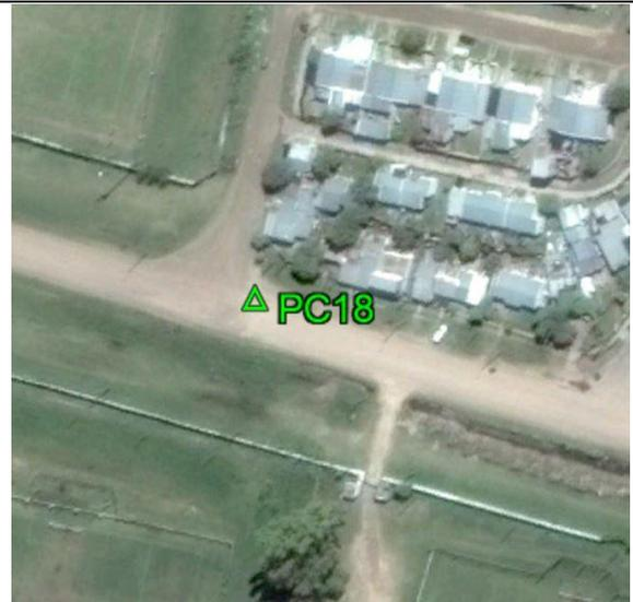
**Fecha:** 02/10/2017**Modo de Levantamiento:** RTK**Tipo / Modelo de antena utilizado:** Trimble/ R8s Internal**Altura / Tipo de Medición de la antena:** 2,000 / Base del montaje**Nombre de archivo Rinex:** -**Observaciones:** Punto fue recogido en la caja de inspección. Todas las unidades están en metros.**Ejecutado por:****Topocart - Topografía, Engenharia e Aerolevanteamento S/S Ltda.**
