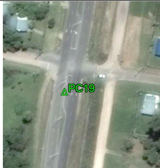
**Fecha: 02/10/2017****Modo de Levantamiento: RTK****Tipo / Modelo de antena utilizado: Trimble/ R8s Internal****Altura / Tipo de Medición de la antena: 2,000 / Base del montaje****Nombre de archivo Rinex: -****Observaciones: Punto recogido en el asfalto. Todas las unidades están en metros.****Ejecutado por:****Topocart - Topografía, Engenharia e Aerolevantamento S/S Ltda.**
