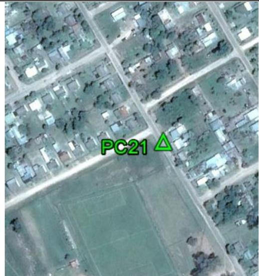
**Fecha: 02/10/2017****Modo de Levantamiento: RTK****Tipo / Modelo de antena utilizado: Trimble/ R8s Internal****Altura / Tipo de Medición de la antena: 2,000 / Base del montaje****Nombre de archivo Rinex: -****Observaciones: Punto recogido en la esquina de la calzada. Todas las unidades están en metros.****Ejecutado por:****Topocart - Topografía, Engenharia e Aerolevanteamento S/S Ltda.**
