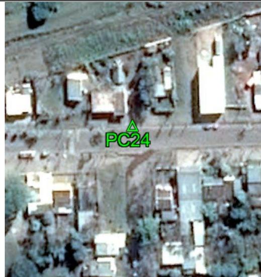
**Fecha: 02/10/2017****Modo de Levantamiento: RTK****Tipo / Modelo de antena utilizado: Trimble/ R8s Internal****Altura / Tipo de Medición de la antena: 2,000 / Base del montaje****Nombre de archivo Rinex: -****Observaciones: Punto fue recogido en el pavimento. Todas las unidades están en metros.****Ejecutado por:****Topocart - Topografía, Engenharia e Aerolevanteamento S/S Ltda.**
