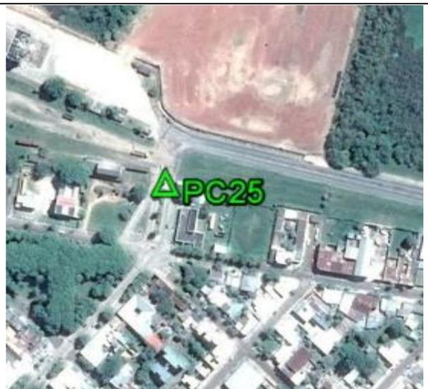
**Fecha: 21/07/2017****Modo de Levantamiento: RTK****Tipo / Modelo de antena utilizado: Trimble/ R8s Internal****Altura / Tipo de Medición de la antena: 2,000 / Base del montaje****Nombre de archivo Rinex: -****Observaciones: Punto recogido en la Avenida. Todas las unidades están en metros.****Ejecutado por:****Topocart - Topografía, Engenharia e Aerolevanteamento S/S Ltda.**
